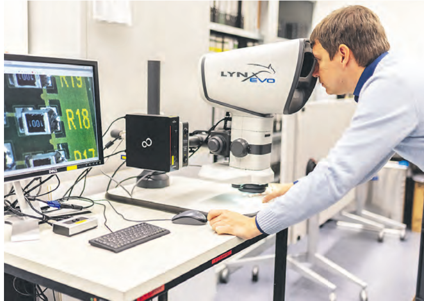
Zwei von drei Arbeitsplätzen im Wissenschaftsbereich entfallen auf Nicht-Akademiker: Der Elektronik-Techniker Tobias Adler im Max-Planck-Institut für Astronomie inspiziert mit einem Spezial-Mikroskop Leiterplatten und elektronische Bauteile. (Foto Dittmer)
