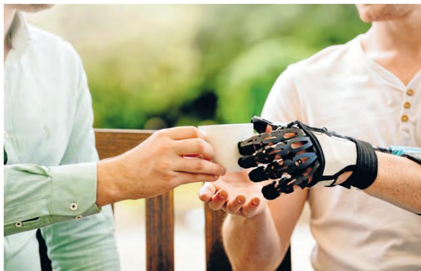
Das Unternehmen Powered Orthotics entwickelt eine weiche Orthese, die dazu dient, die Bewegungsfunktion einer schwachen Hand wiederherzustellen. (Foto Powered Orthotics)
