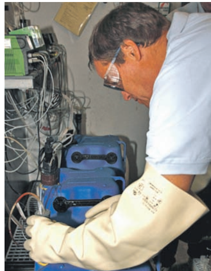
Beim Wechsel des Laugebehälters.
