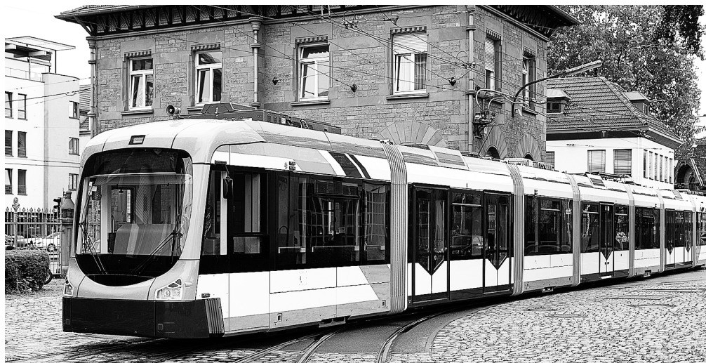
Fährt auch ohne Oberleitung: Die Straßenbahn von Bombardier mit Mitrac Energy Saver. Foto: RNV
